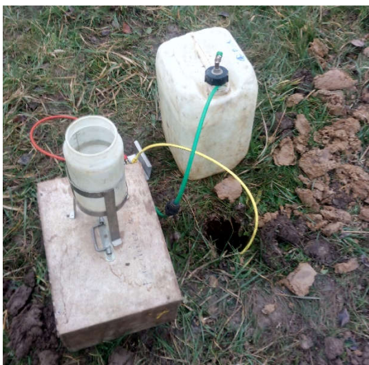
Figure 2.1 : Exemple d'essai Porchet
