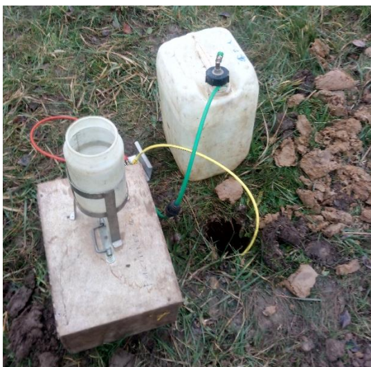
Figure 2.1 : Exemple d'essai Porchet
