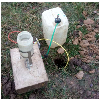
Figure 2.1 : Exemple d'essai Porchet
