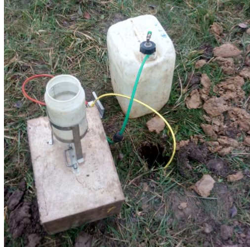
Figure 2.1 : Exemple d'essai Porchet
